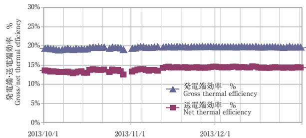
図5 発電端・送電端効率トレンド（日平均）
