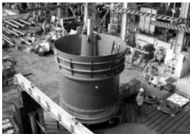
口径3600 mm 立軸軸流ポンプ/工場仮組み状況
