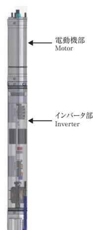
図4 インバータの構造
