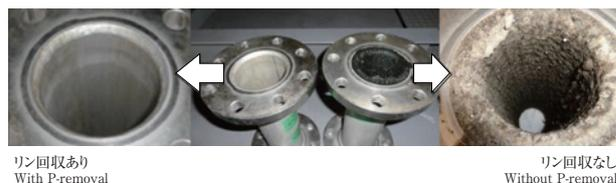
写真2 実証試験後のテスト配管状況
